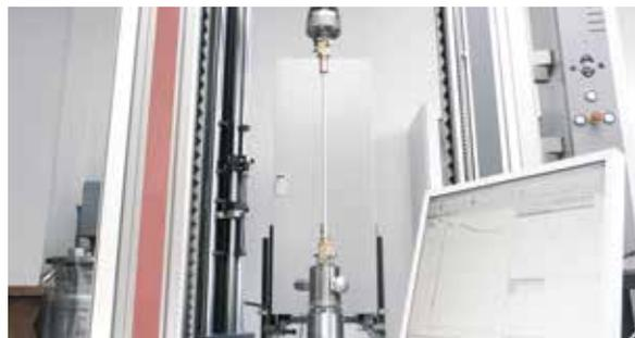
Рис. 3 Ход испытания на растяжение
