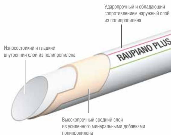
Рис. 58 Конструкция трубы RAUPIANO PLUS
