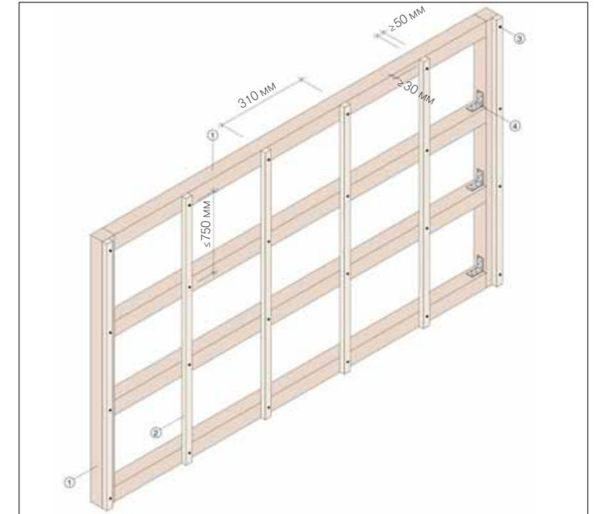
3 Рис. 28: Указания по исполнению каркасных конструкций
