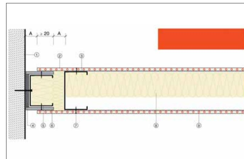
3 Рис. 35: Пример схемы скользящих швов примыкания фасадов
