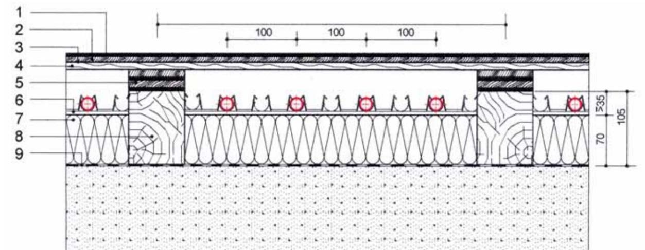
6 Рис. 18: Конструкция напольного отопления с виброполами
