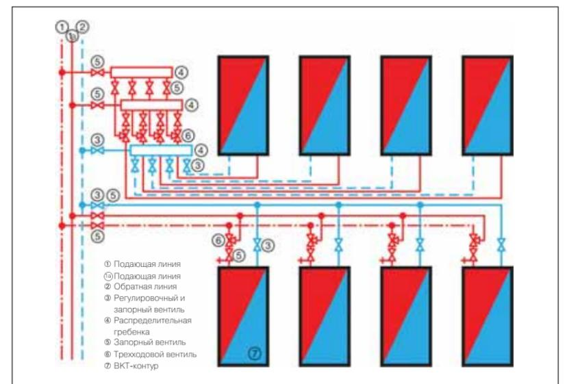
5 Рис. 52: Схематичное представление трехтрубной системы
