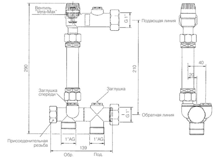
1 Рис. 61: Размеры комплекта для установки теплосчетчика REHAU
