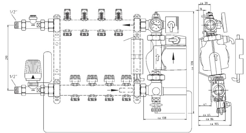
1 Рис. 68: Комплект температурного регулирования с постоянными параметрами
