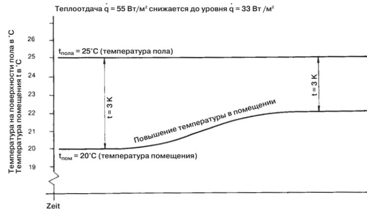
1 Рис. 63: Графическое представление эффекта саморегулирования
