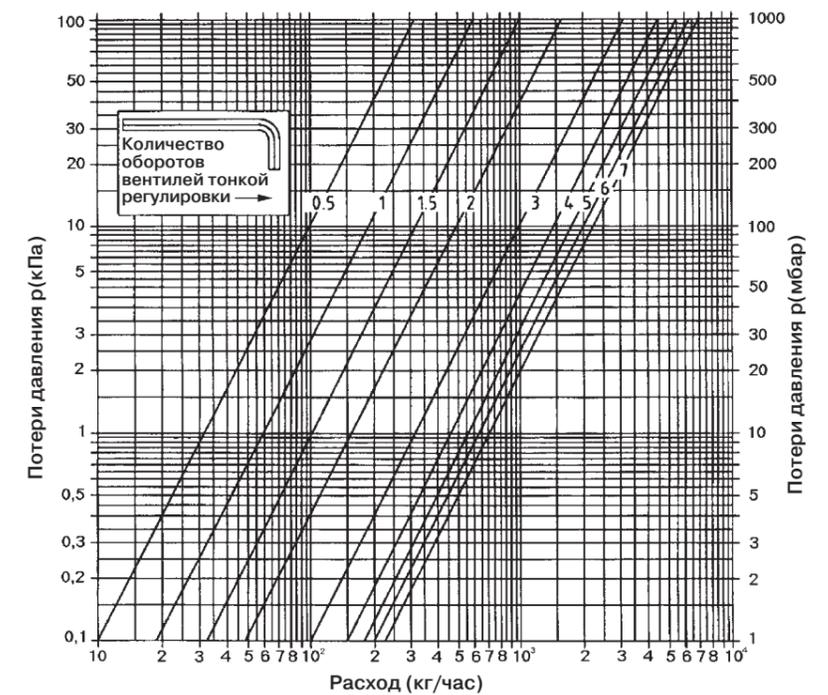
1 Рис. 62: Диаграмма для определения величины установочной регулировки расхода вентиля тонкой регулировки комплекта для установки теплосчетчика.
