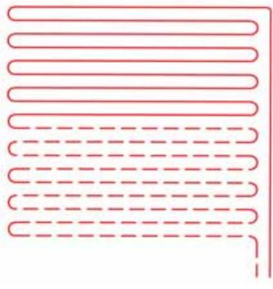
1 Рис. 83: Метод укладки змеевик
