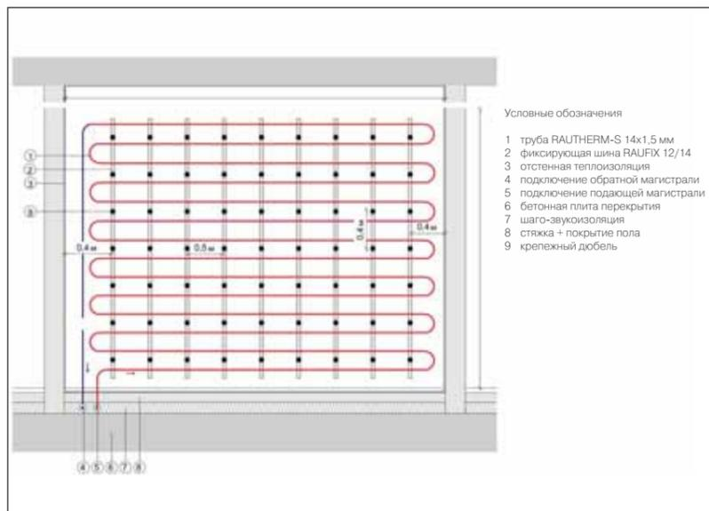
3 Рис. 15 Схематичное изображение системы настенного отопления REHAU с укладкой труб змеевиком при "мокрый" способе монтажа
