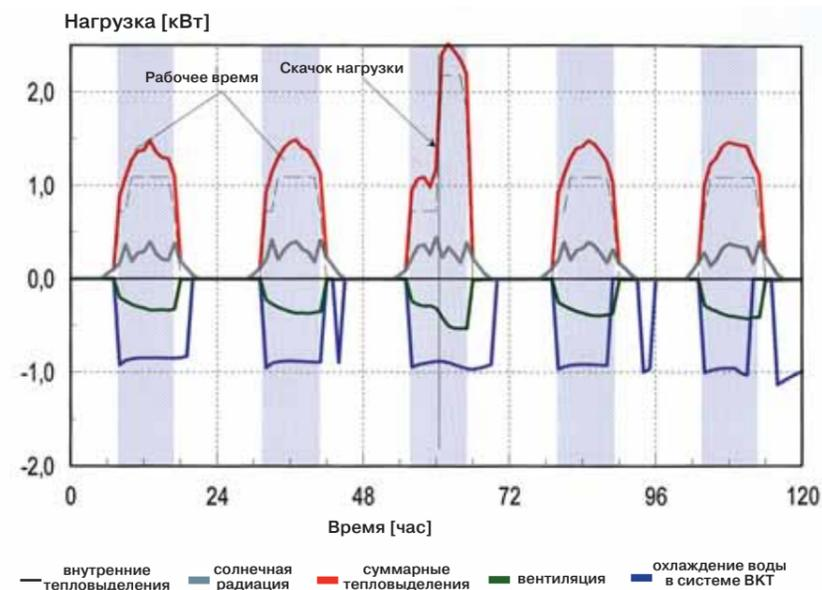
5 Рис. 39: График нагрузок в режиме охлаждения/Вариант А
