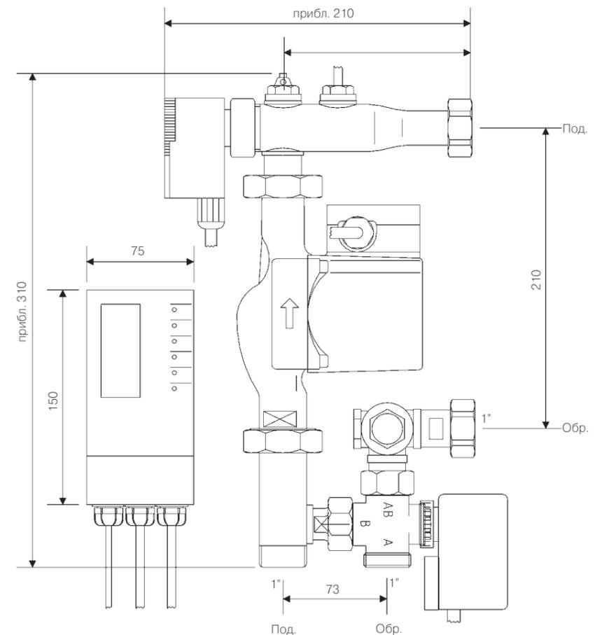
1 Рис. 71 : Размеры терморегулирующей станции TRS-T
