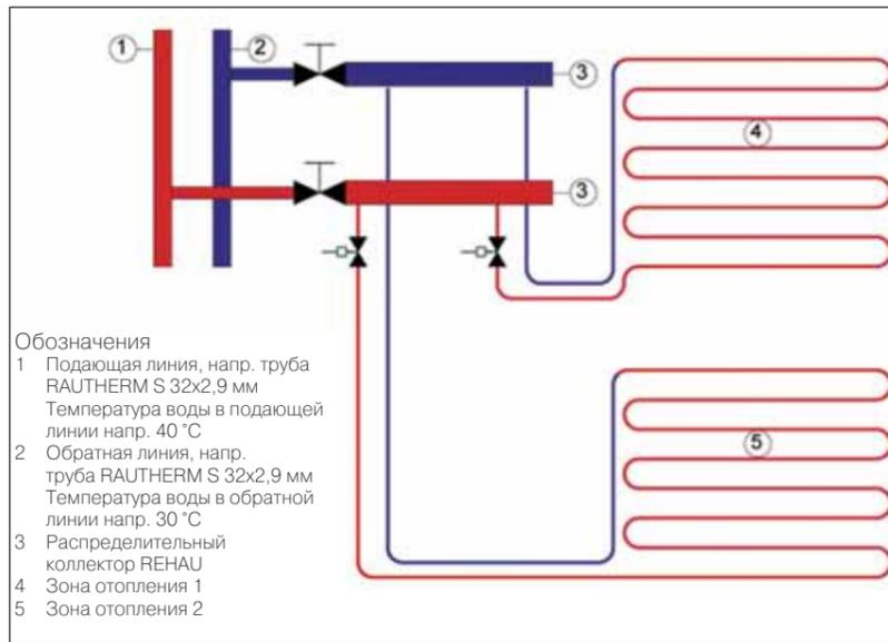
4 Рис. 2: Схематическое представление коллекторного присоединения зон отопления
