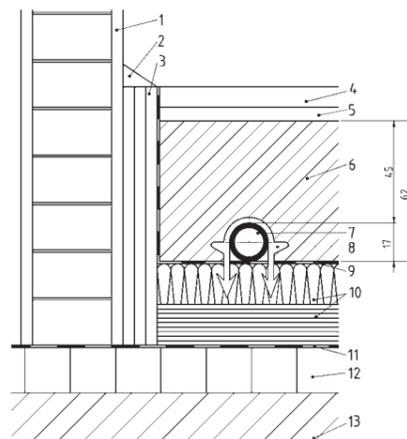
Монтаж на матах (комбинированная тепло и шаго-звукоизоляция) Трубы RAUTHERM-S в разрезе
