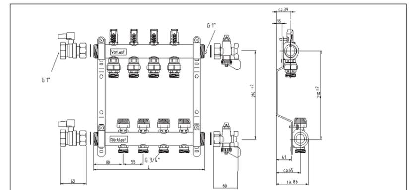
1 Рис. 55: Присоединительные размеры распределительного коллектора НКВ-D
