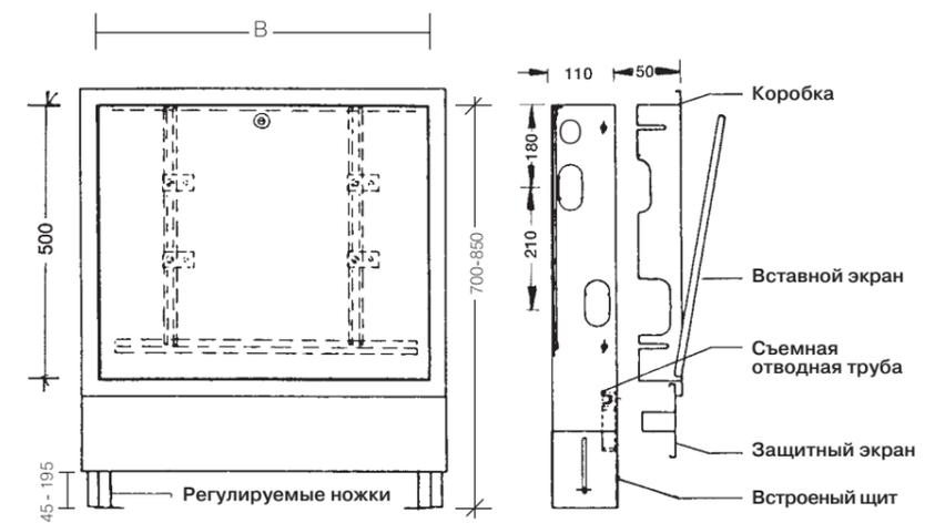
1 Рис 57: Присоединительные размеры встроенного распределительного шкафа
