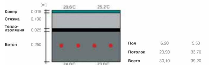
5 Рис. 47: Конструкция плиты 2
