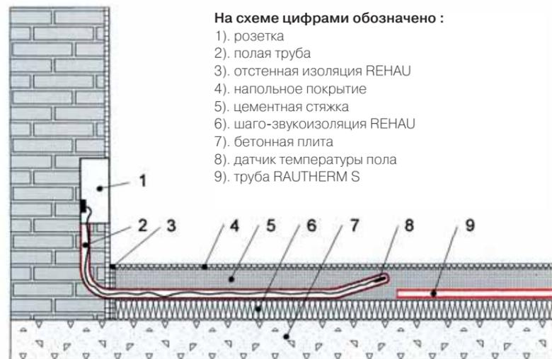
1 Рис. 97: Монтаж датчика температуры пола
