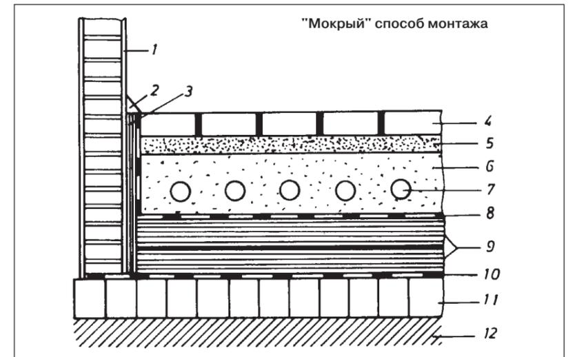
1 Рис. 76: Конструкция пола при "мокром" способе монтажа.
