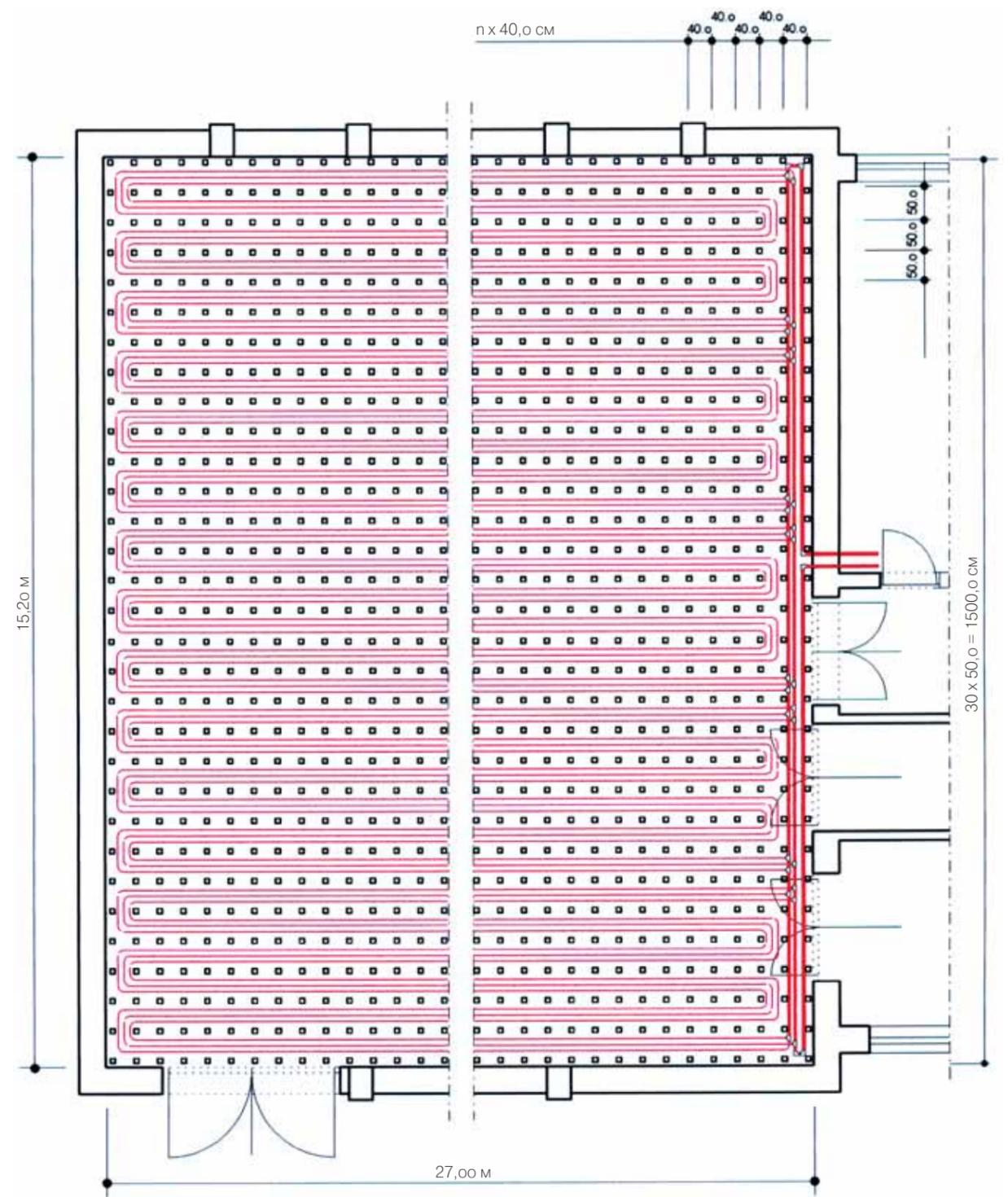
6 Рис. 26: Пример укладки системы напольного отопления REHAU в спортивном зале с виброполами и трубным распределительным коллектором
