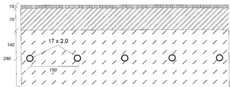
5 Рис. 37: Конструкция плиты перекрытия ВКТ в разрезе
