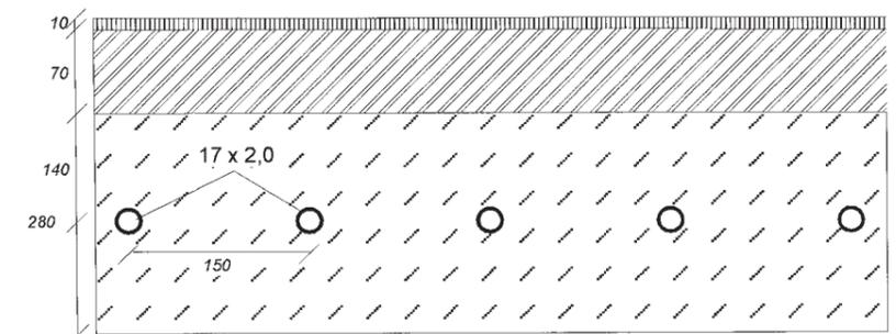
5 Рис. 43: Конструкция плиты перекрытия ВКТ в разрезе
