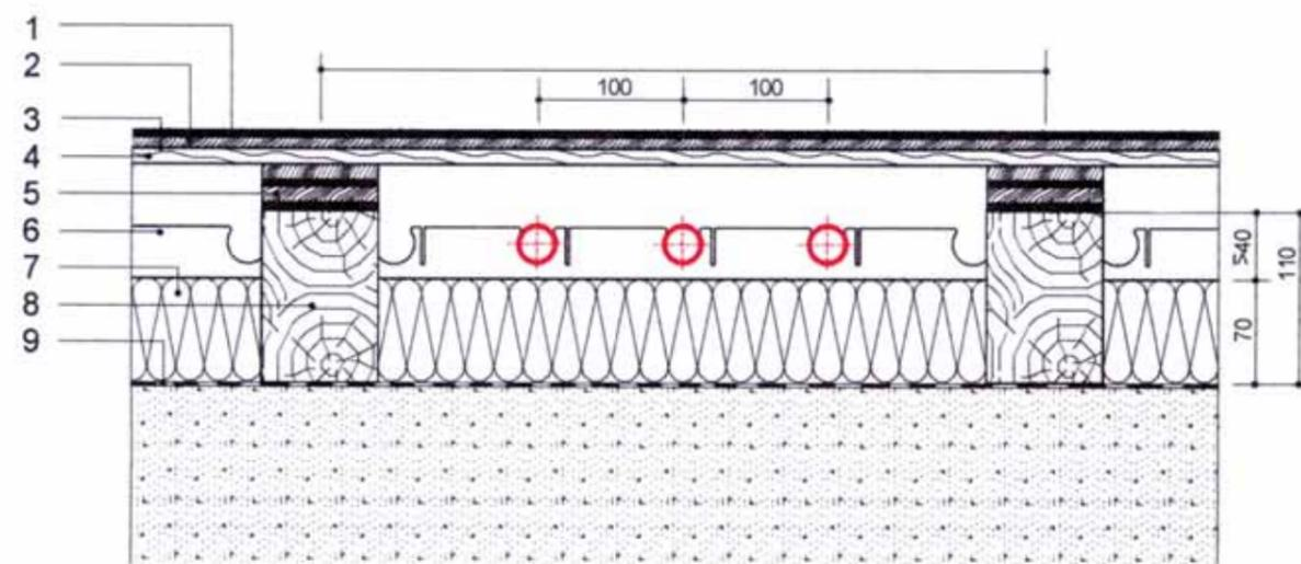
6 Рис. 24: Конструкция амортизирующего пола
