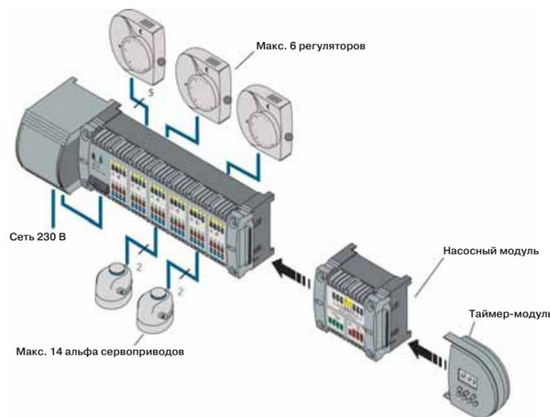
1 Рис. 72: Схема подключения компонентов прибора RAUMATIC M
