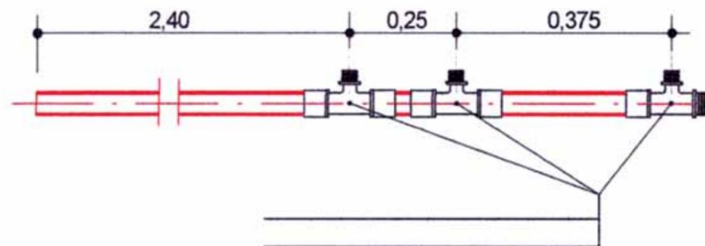
6 Рис. 23: Распределительный коллектор REHAU
