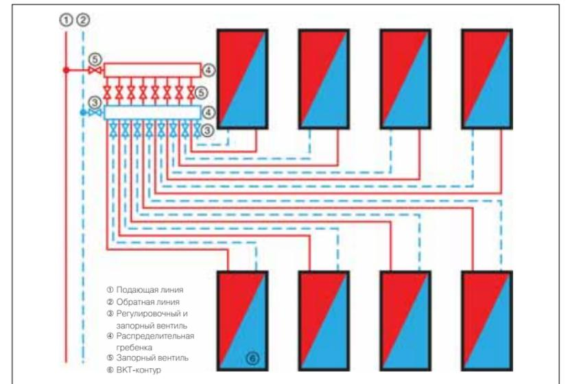
5 Рис. 50: Схема подключения к коллектору
