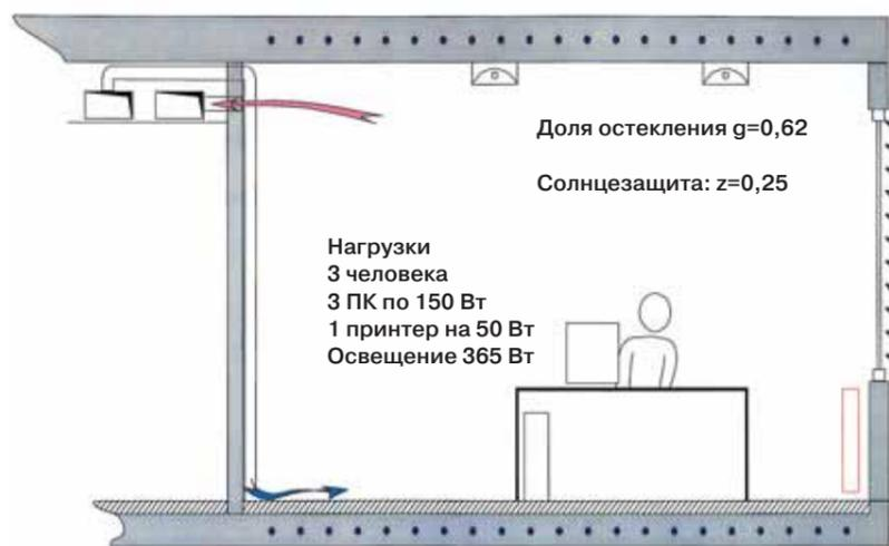
5 Рис. 36: Поперечный разрез представительного помещения/Вариант А
