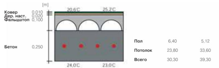
5 Рис. 49: Конструкция плиты 4
