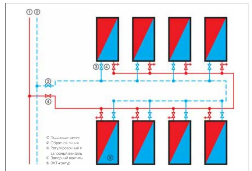
5 Рис. 51: Схематичное представление двухтрубной системы
