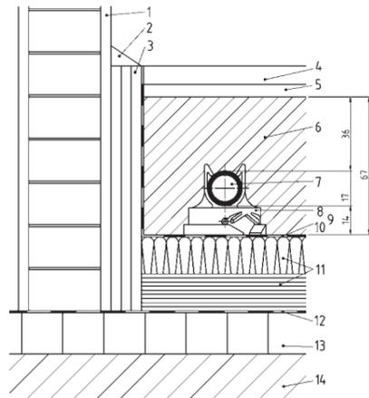
Монтаж на металлической сетке (RTM) при помощи поворотных клипс для крепления трубы RAUTHERM S
