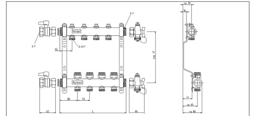
1 Рис. 54: Присоединительные размеры распределительного коллектора НКВ
