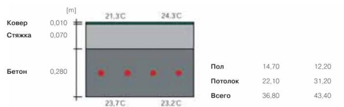
5 Рис. 48: Конструкция плиты 3
