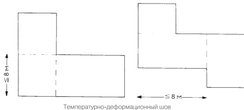
1 Рис. 88: Устройство швов
