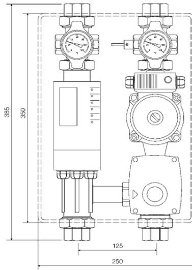
1 Рис. 65: Терморегулирующая станция TRS-20
