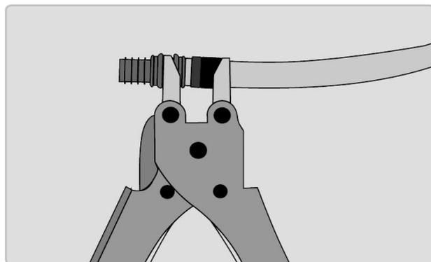
4. С помощью инструмента для запрессовки монтажных гильз надвинуть гильзу на фитинг.
