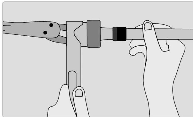
2. С помощью расширительного инструмента расширить окончание трубы.
