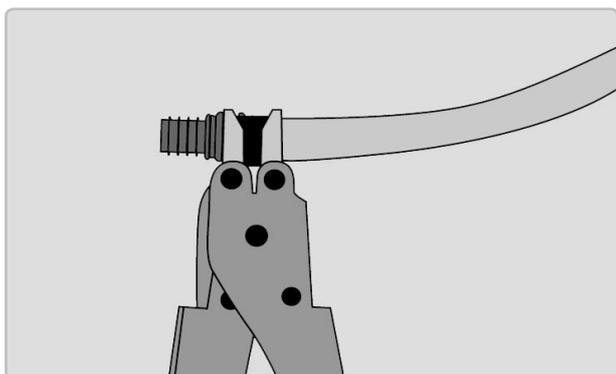
5. Убедиться, что монтажная гильза дошла до упора фитинга (допускается зазор до 1.5 мм).
